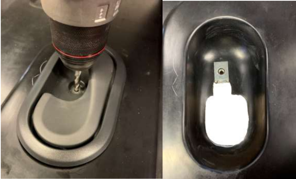
Figure 20: Perçage et mise en place du clip écrou
