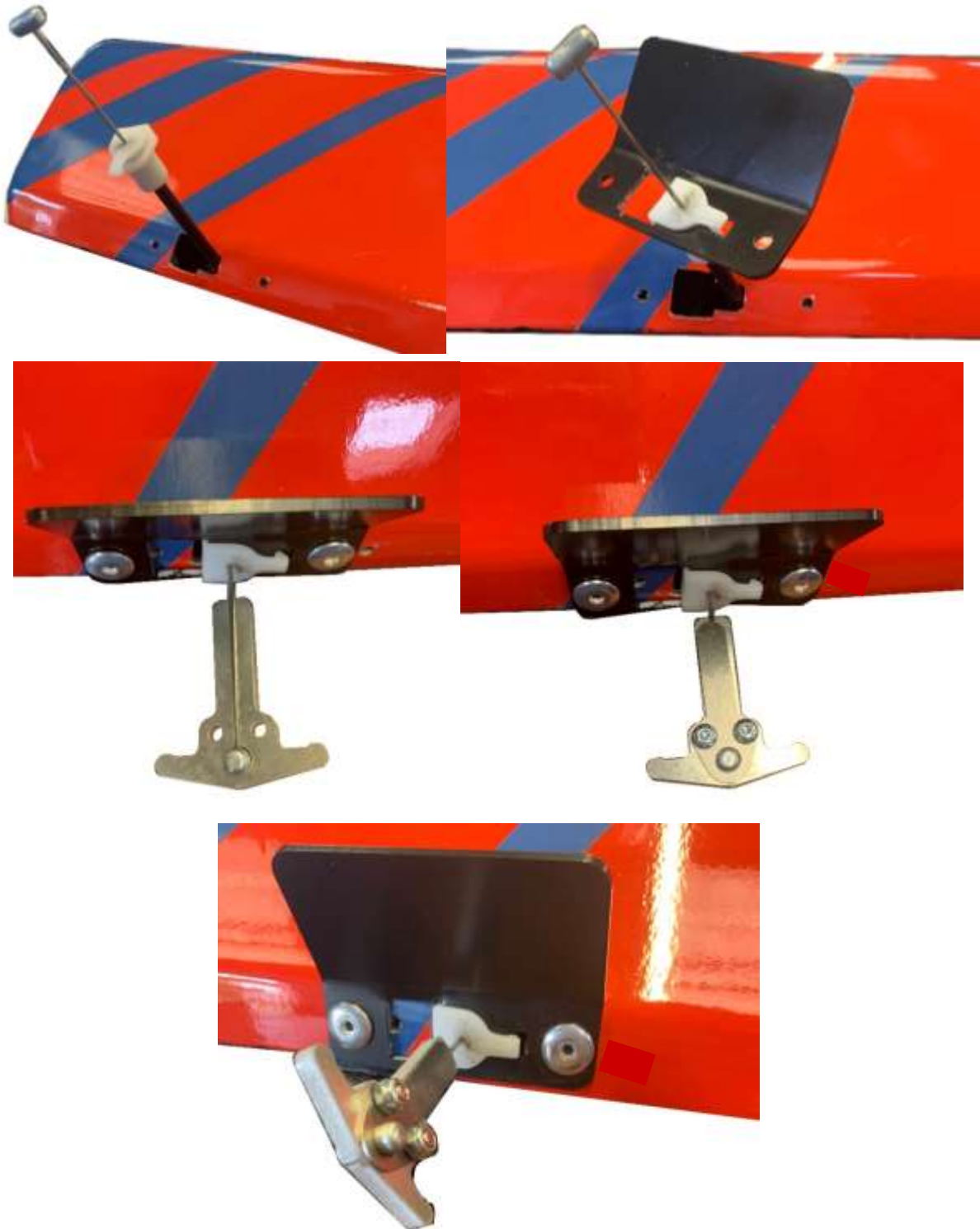
Figure 34: Assemblage du système d'ouverture de porte
