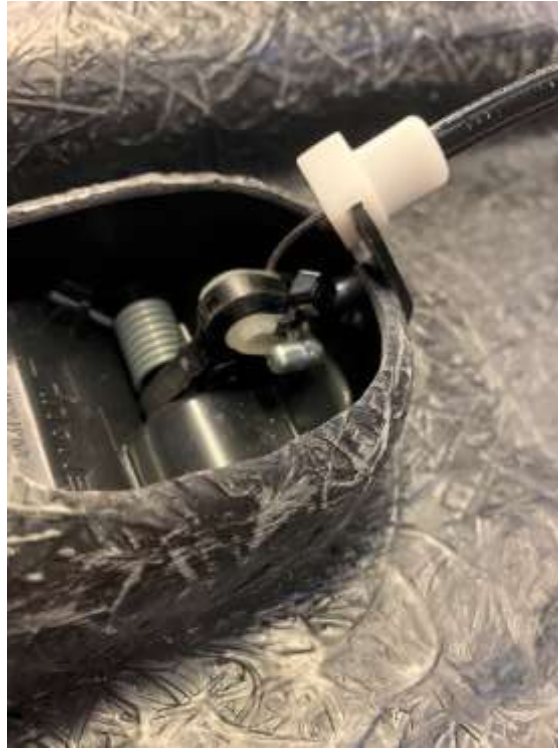
Figure 29: Assemblage du câble avec cylindre et de la poignée
