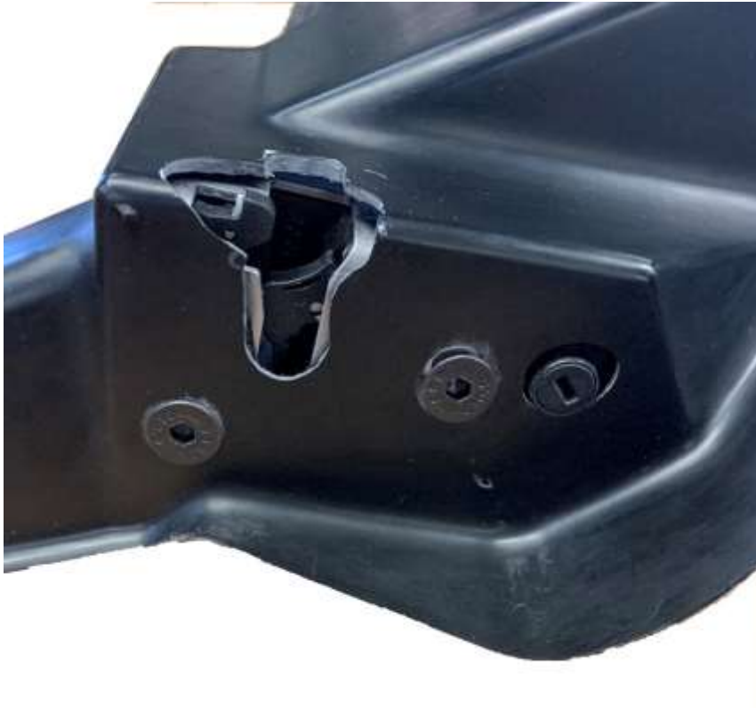
Figure 27: Perçage et mise en place de la serrure de porte
