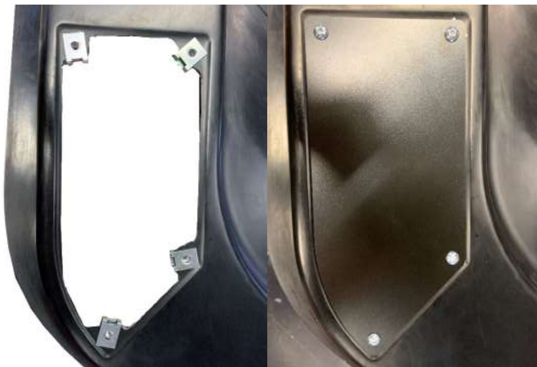
Figure 23: Mise en place de la tôle de fermeture de porte
