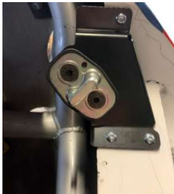
Figure 18: Assemblage de la gâche avec le support de gâche
