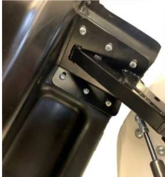
Figure 38: Porte avec cales supérieures et inférieures
