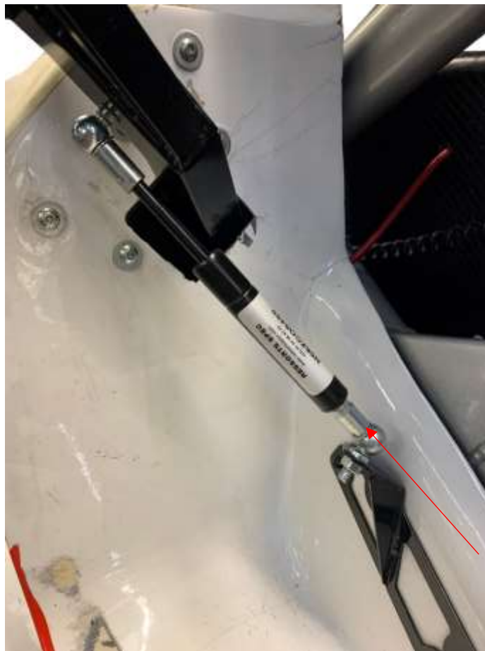
Figure 16: Vérin assemblé sur support de vérin
