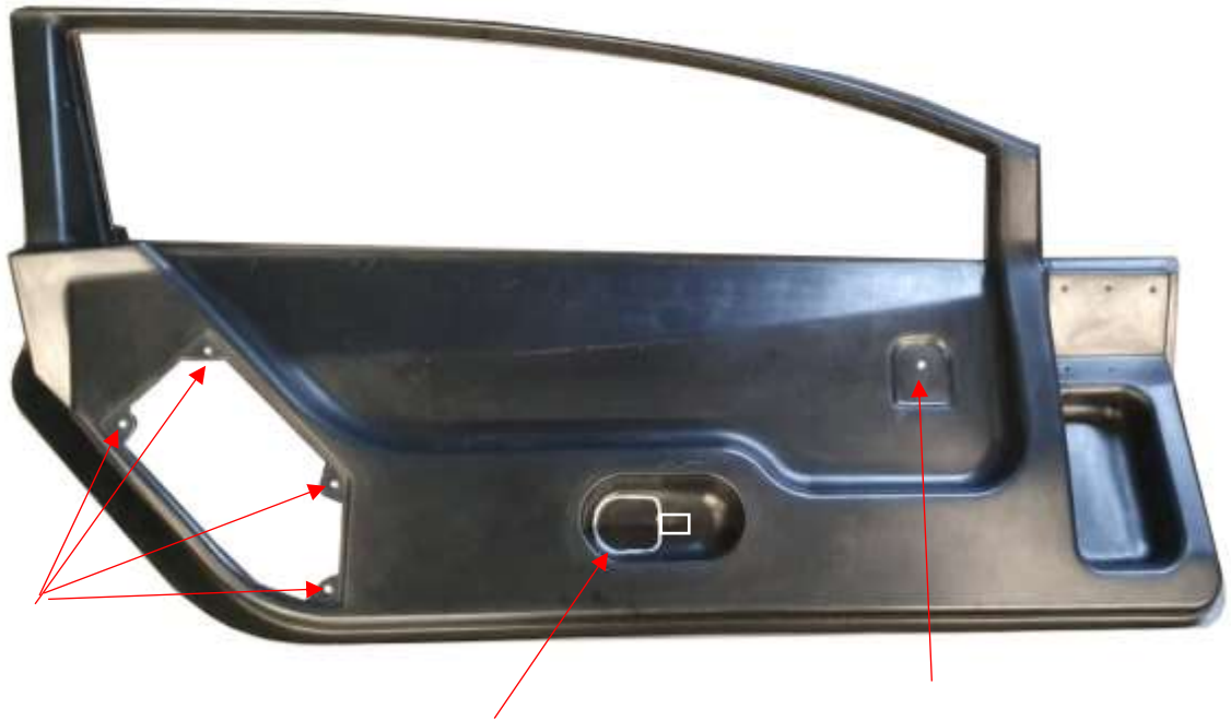
Figure 19: Emplacement pour perçage et découpage
