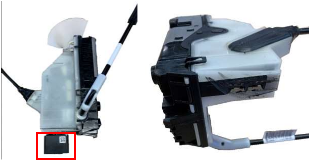
Figure 25: Avant/Après coupe de la cosse électrique
