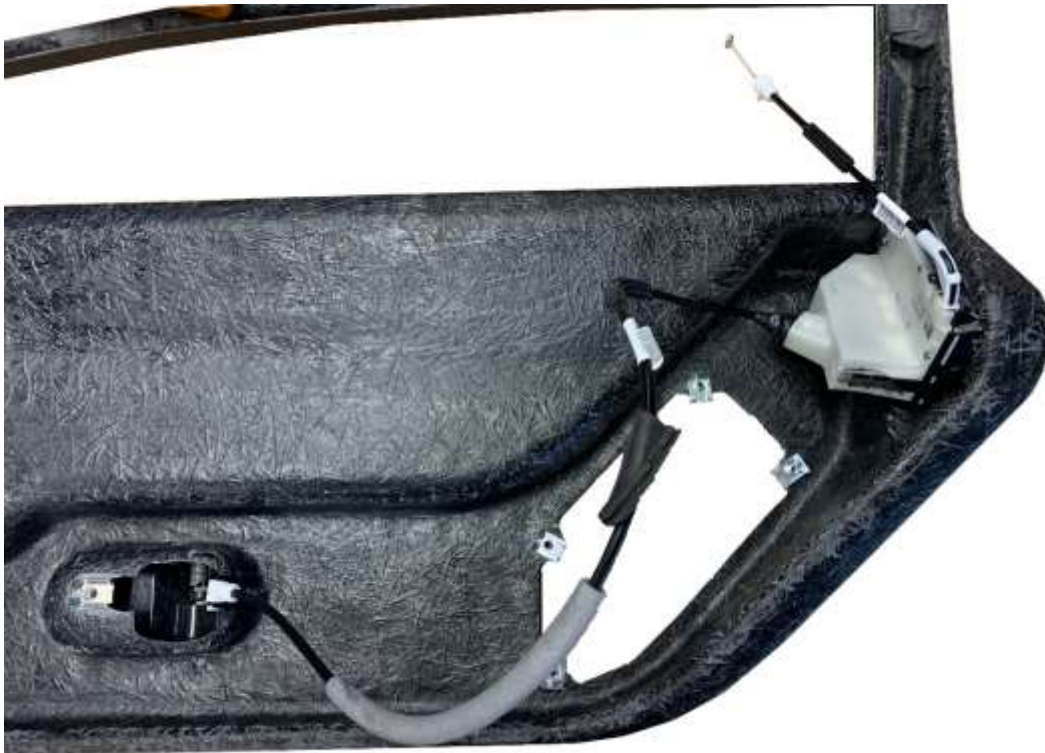
Figure 27: Perçage et mise en place de la serrure de porte
