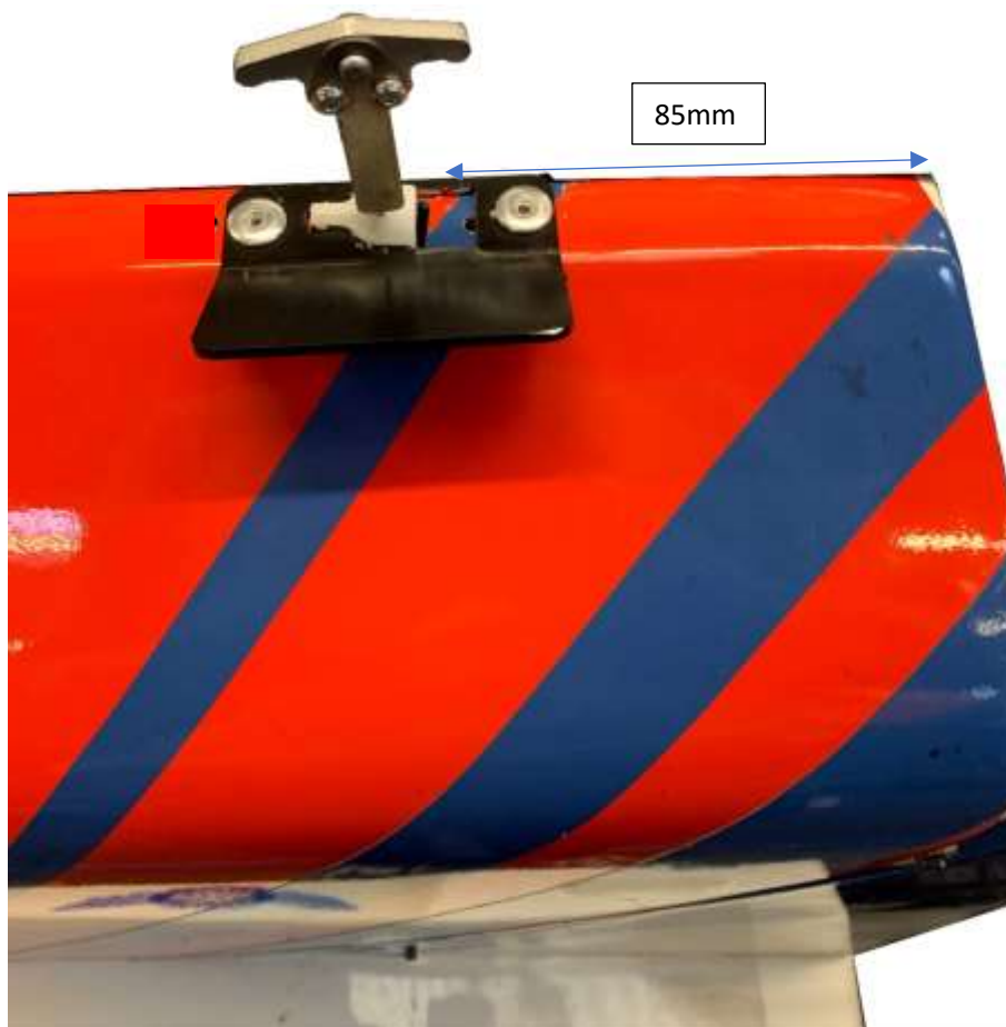
Figure 32: Distance jusqu'à l'extrémité de la porte
