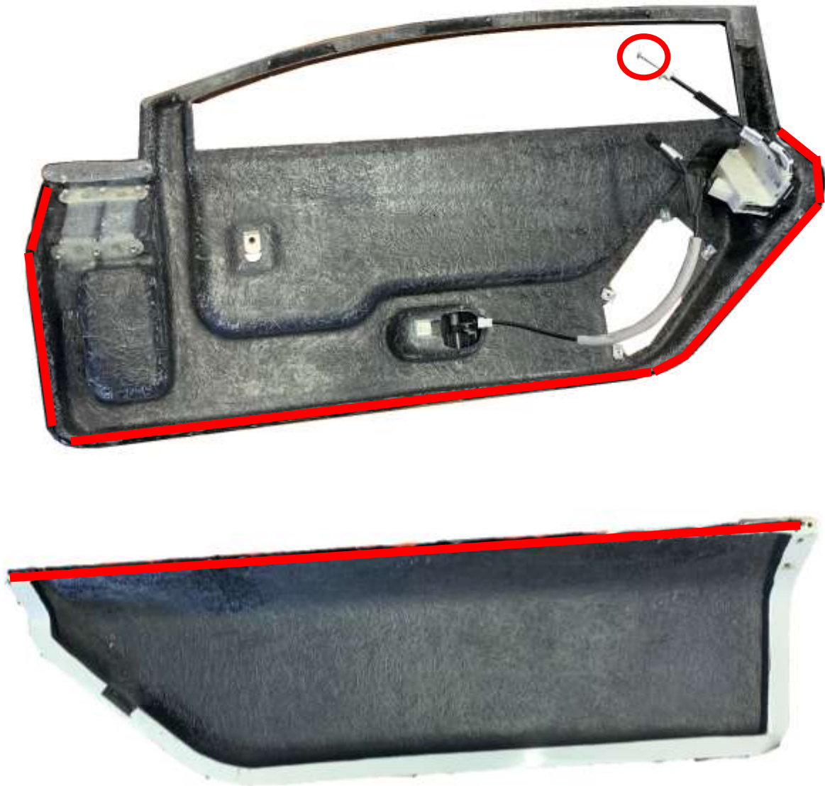
Figure 33: Repérage des parties à enduire de colle
