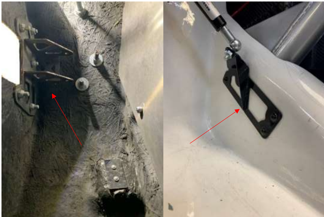
Figure 10: Charnière de porte et tôle support vérin
